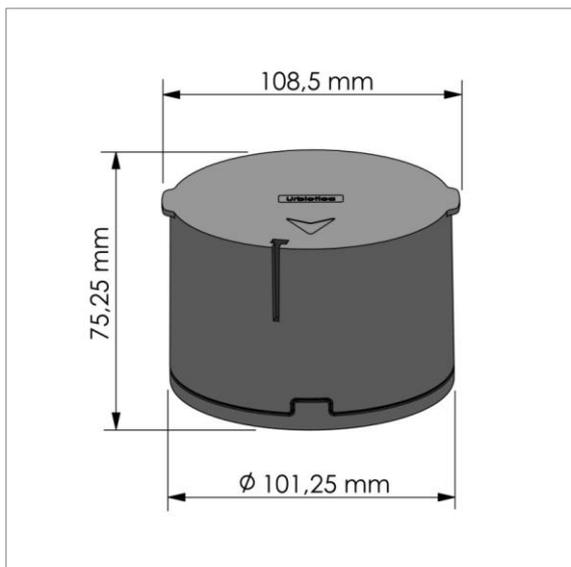
**U-Flow** es un **sensor de tráfico** inalámbrico que **detecta** las **variaciones del campo magnético terrestre** que se producen por el paso de vehículos.
